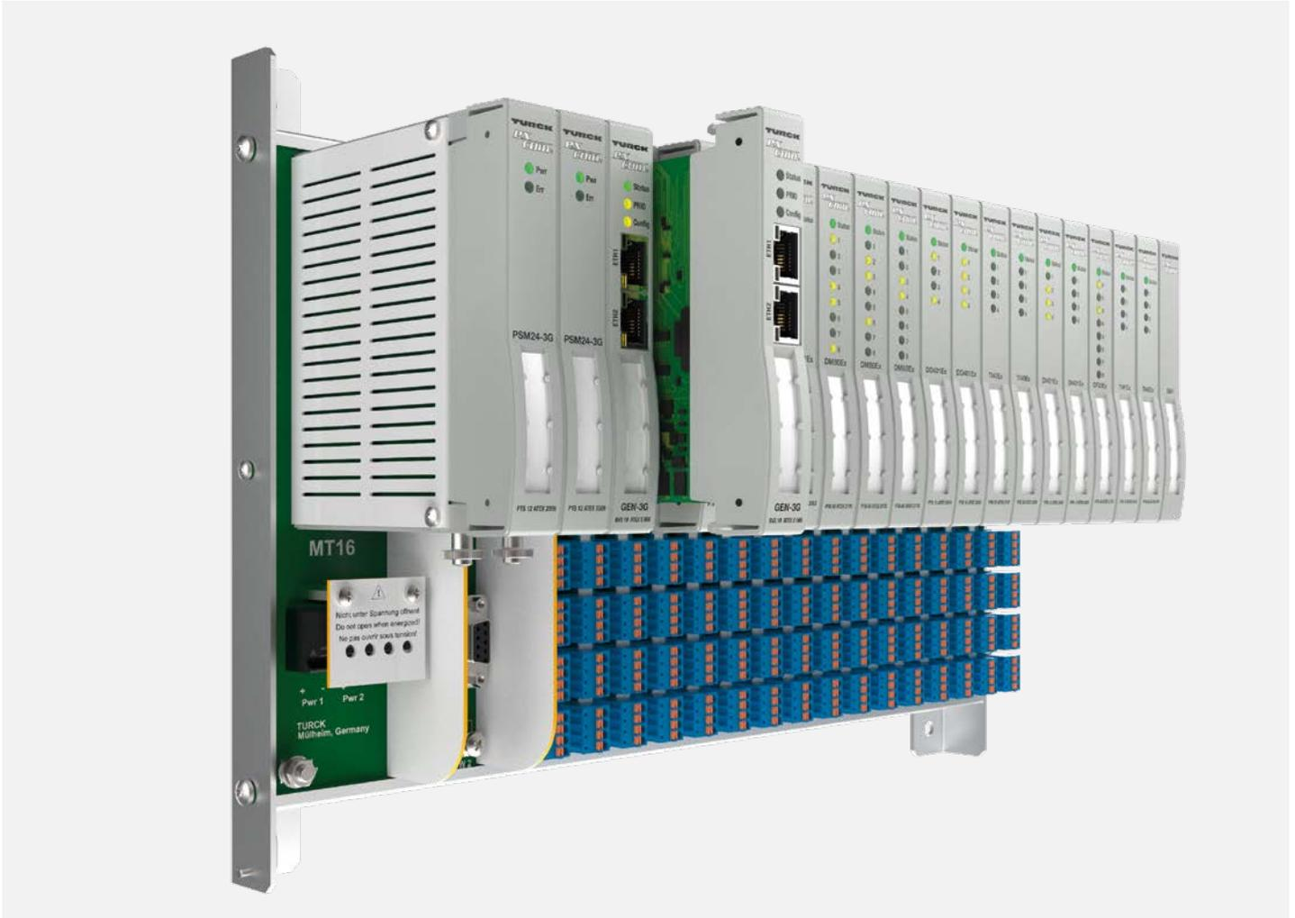
Mit excom bietet Turck ein universelles I/O-System, das Sie in Zone 1/21 ebenso installieren können wie in Zone 2/22 oder im Nicht-Ex-Bereich. Die Feldstromkreise sind für Zone 0 zugelassen. Sie profitieren dabei nicht nur von Komponenten, die für die jeweilige Einsatzzone optimiert wurden, sondern auch von einem einheitlichen Konzept zur Konfiguration und Parametrierung der Peripherie und der Feldinstrumentierung.
