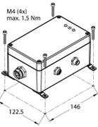
**Блок переключателей для отключения напряжения привода V2**
